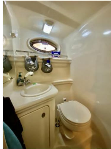
WC-Raum mit Vacuum-WC
